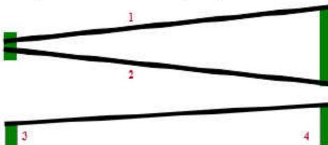
Cuando se deja descansar un cilindro sobre la rampa, éste se va a desplazar hacia abajo, desde 4 hasta 3. Sin embargo, si se hace lo mismo con el artilugio de la figura (formado por dos embudos cónicos pegados por la boca ancha), ¡se va a mover por sí mismo hacia arriba!
