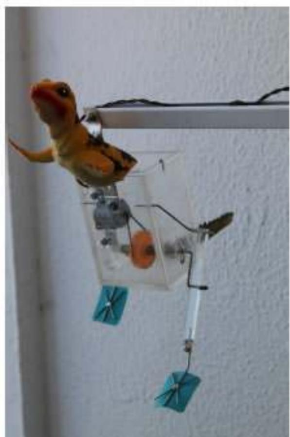
Consta de un motor eléctrico que mueve un sistema que simula las dos patas del lagarto. Está fijado a un eje, de manera que se mueve en círculos en una piscina. Cuando está quieto, como es más denso que el agua, se hunde. Pero cuando se conecta el motor y comienza a mover las patas...
